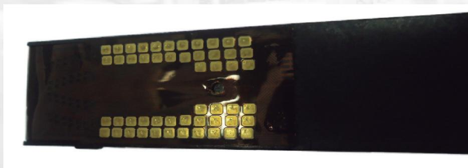
FOTO 10: CONTATO ELÉTRICO DO CARTUCHO
